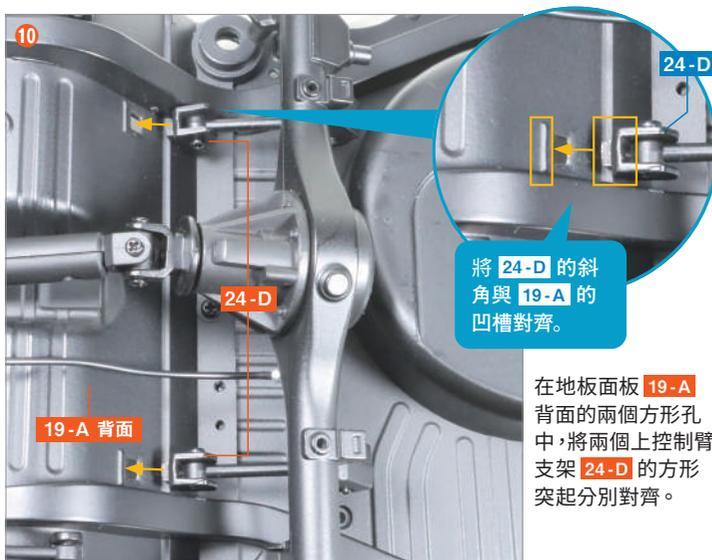
在地板面板 19-A 背面的兩個方形孔中，將兩個上控制臂支架 24-D 的方形突起分別對齊。
