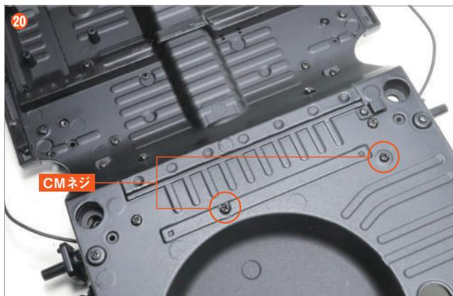
壓住 27-D 避免其脫落的同時，將地板面板翻轉到正面，然後使用 CM 螺絲 將兩個位置固定。
