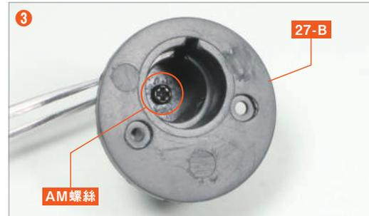
將 27-C 翻轉避免其脫落，以 AM 螺絲 固定。請確保 27-C 可以旋轉，注意不要把螺絲鎖得太緊。
