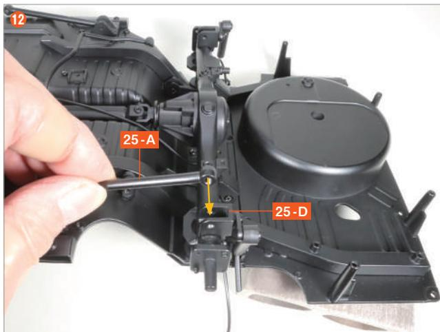
將第25期安裝在地板面板背面的下控制臂 **25-A** 的前端，插入到後避震器支架·R (1) **25-D** 的「ㄇ」字形之間。
