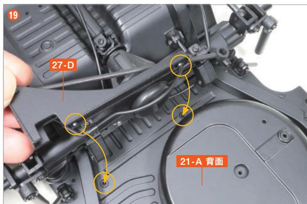
將 27-D 兩個螺絲孔的突起部分與後地板面板 21-A 背面的兩個凹槽對齊，然後插入。
