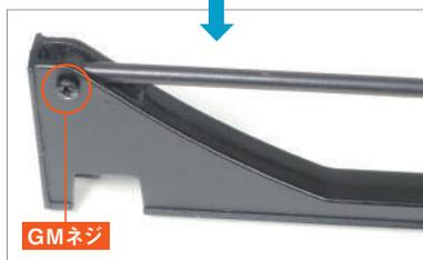
將橫向操縱桿 27-E 的較小螺絲孔，插入到橫向操縱桿支架 27-D 的螺絲孔之間，然後用 GM 螺絲 固定。
