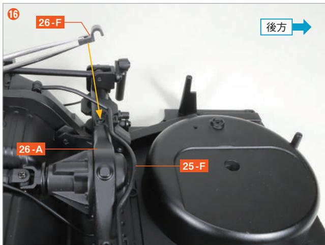
將後防傾桿 **25-F** 往後方放，然後再把後防傾桿栓 **26-F** 放在後軸殼下側 **26-A** 上。
