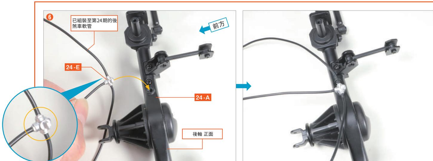
將第24期中組裝好的後煞車軟管的煞車軟管連接器 **24-E** 的半圓形突起部分，對齊嵌入後軸殼上側 **24-A** 的半圓形孔中。
